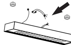
Com a rede elétrica desligada, conecte os cabos e isole com fita isolante anti-chamas
