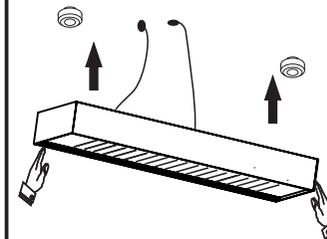
Fixar a luminária no teto, encaixando nos fixadores de teto
