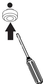
Fixe os terminais de encaixe nos furos no teto
